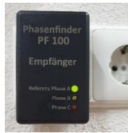
zu prüfende Steckdose 1 grüne LED: Phase A erkannt
