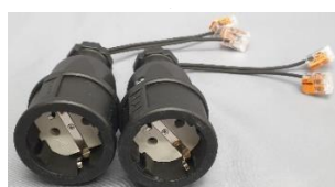
optionale Adapter zur Prüfung der Phasenverteilung an offenen Installationsleitungen
