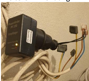
optionale Adapter zur Prüfung der Phasenverteilung an offenen Installationsleitungen
