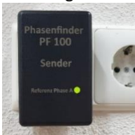
Sender in Referenzsteckdose grüne LED blinkt = Phase A
